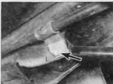
20.9a Снимите опорный кронштейн вторичного троса с компонентов подвески (стрелка)...
