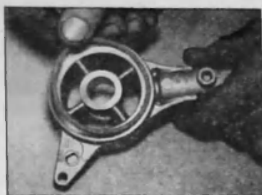
12.5b O-кольцевое уплотнение расположено в канавке корпуса
