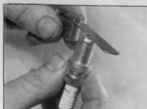
31.9a Измерение зазора свечей зажигания щупом
