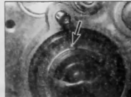
4.11a Поплавковый клапан должен быть направлен вверх
