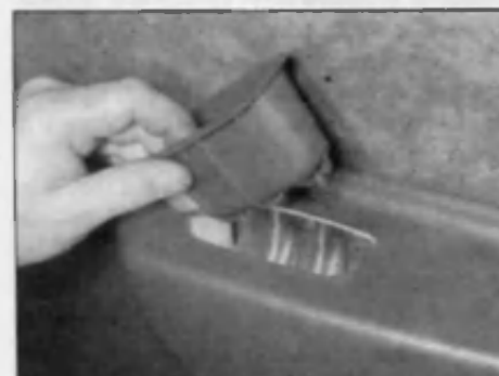
12.3 Снимите декоративную накладку ручки передней двери
