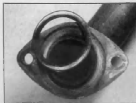
16.5 Приемная труба глушителя с прокладкой
