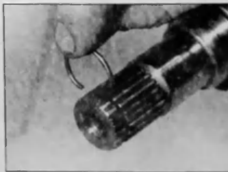
2.12 Снимите стопорное кольцо с шлицевого хвостовика внутреннего шарнира равных угловых скоростей
