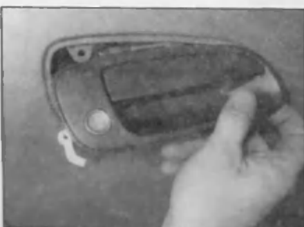
13.19 Снятие наружной ручки и цилиндра замка передней двери
