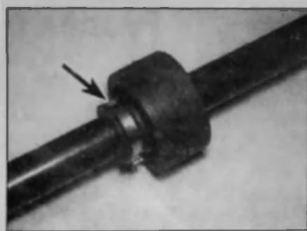
3.43 Правый ведущий вал с демпфером и хомутом (отмечен стрелкой)
