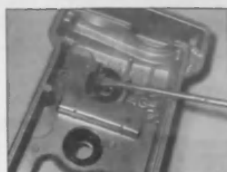
4.6a Извлеките уплотнения свечных трубок...
