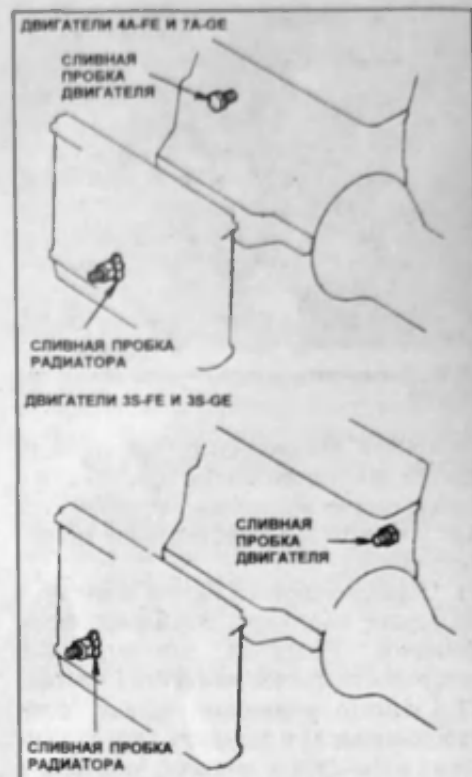
36.2 Местоположения сливных пробок блока цилиндров (двигателя) и радиатора
