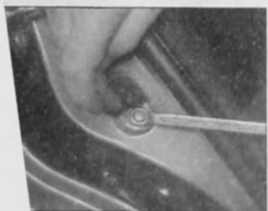
Снятие выключателя предупреждения запорной двери
