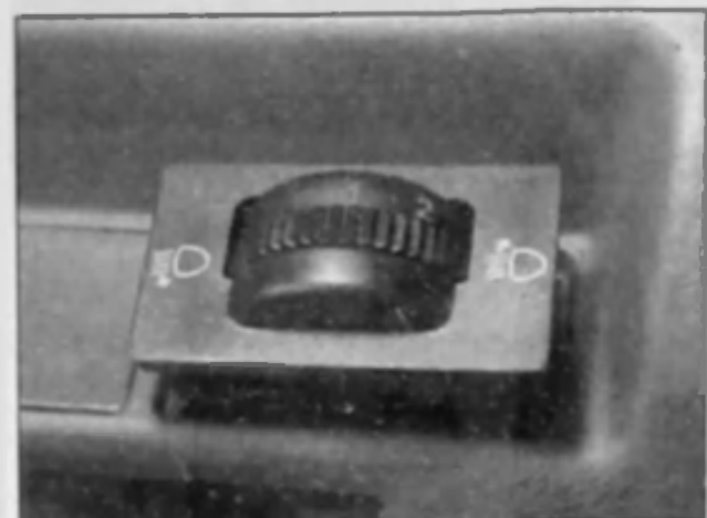
4.6a Снимите выключатель регулировки положения фар с приборной панели...
