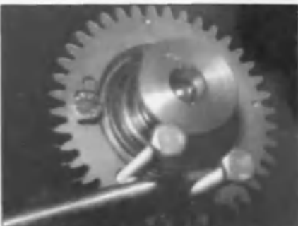
В.12a Установите два болта для фиксации ведомой шестерни впускного распредела
