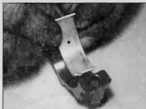
9.6b Извлеките нижнюю половину вкладыша подшипника из крышки нижней головки шатуна
