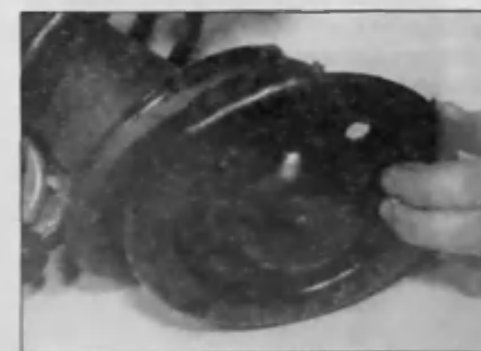
4.10c ...верхнюю опорную чашку пружины
