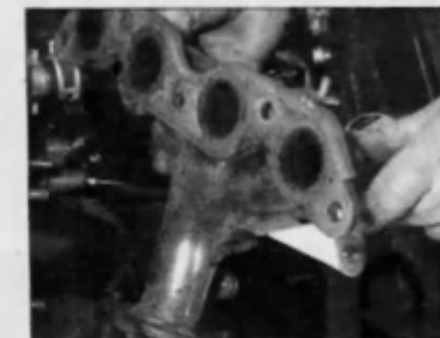
15.5c ...и извлеките выпускной коллектор из шпилек головки цилиндров
