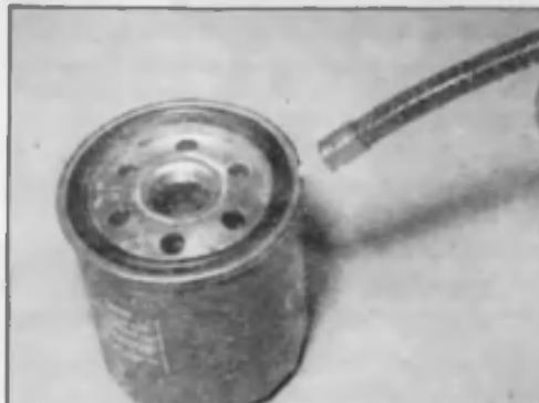
3.11a Смажьте тонким слоем чистого моторного масла кольцевое уплотнение нового фильтра
