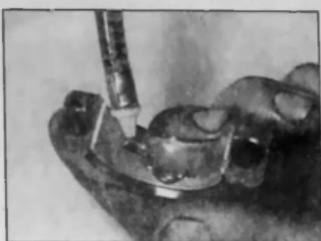
18.21а Перед установкой крышки смажьте нижний вкладыш шатунного подшипника
